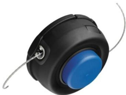
Cabezal semiautomático para desbrozadora Husqvarna T35 M10 [578446301](#) exclusivamente diseñado por Husqvarna el T35 dispone de un sistema de inserción de hilo semi-automático: Tap'n go. El hilo de corte se inserta automáticamente en cuanto el trimmy toca el suelo, esto significa que el usuario siempre controla la inserción del hilo y lo puede hacer mientras trabaja con la máquina. Modelos compatibles: 125L/R/RJ 323L/R/RJ 325RX 133R.
