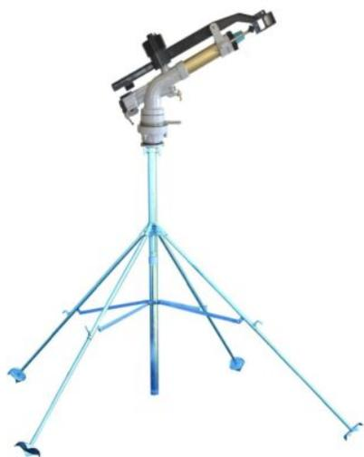
El cañón de riego Eagleo ATOM42 PC de la marca Ducar tiene un cabezal de aspersión de alto rendimiento, pero también es ajustable al rango de ajustes de ángulo deseado. Es de tipo impacto y de presión media. proporciona un riego óptimo con una distribución homogénea del agua gracias a las boquillas de aspersor intercambiables y el doble orificio de salida de agua. Apto para el riego de todo tipo de cultivos de campo y verduras.
