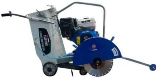
Cortadora de concreto marca FIAT modelo RABIATA, tiene un motor de 14 hp. Con un diseño liviano y ergonómico que la hace fácil de usar durante períodos prolongados.
