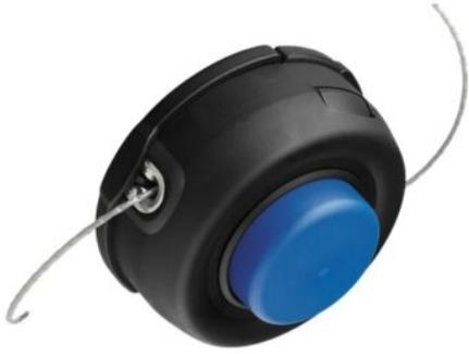
Cabezal semiautomático para desbrozadora Husqvarna T35 M12 [578446401](#), presenta un sistema de alimentación del cable semiautomático que Husqvarna también llama TapanGo. La línea de la recortadora se alimenta automáticamente cuando la cabeza se empuja hacia el suelo.
