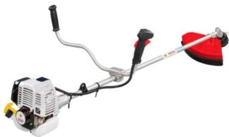
La desmalezadora Shell SHB3528 es una herramienta potente y versátil para el cuidado del jardín. Su motor de 35cc y 4 tiempos ofrece un rendimiento óptimo y una mayor durabilidad. Además, cuenta con un sistema de arranque fácil, un manillar ergonómico y un cabezal de corte de nylon. La desmalezadora Shell SHB3528 es ideal para cortar hierbas altas, malezas y arbustos con facilidad y comodidad.
