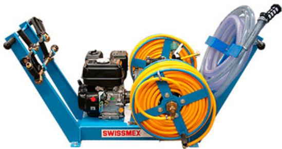
Parihuela fumigadora agrícola Pick Up Classic, diseñada para realizar aplicaciones de manera dirigida en forma nebulizada de insecticidas, fertilizantes, fungicidas.
