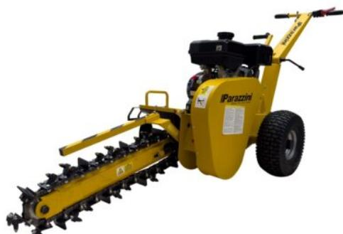
La **Zanjadora Parazzini** con **motor de 15 hp** con doble filtro puede usarse para una gran variedad de tareas que oscilarían entre trabajos de zanjado ligero y de alto rendimiento. Las profundidades de **excavación varían entre 20 cm y 60 cm**. El desplazamiento lateral le permite trabajar junto a muros o vallas.
